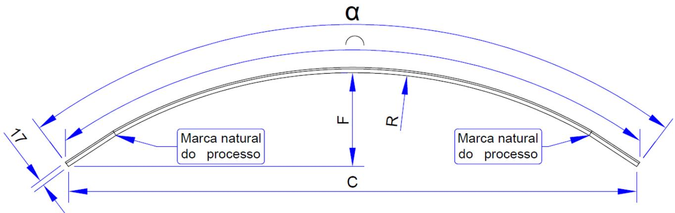
Figura 01 - Desenho técnico para calandrar uma telha ondulada RT17/980
